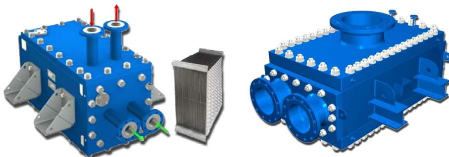
Сварные теплообменники применяются в условиях высоких температур и давлений, на большие единичные тепловые мощности 10-100 МВт и более, часто используется в качестве паровых конденсаторов, для нагрева-охлаждения агрессивных сред в тех случаях, когда использование резиновых уплотнений не рекомендуется.
